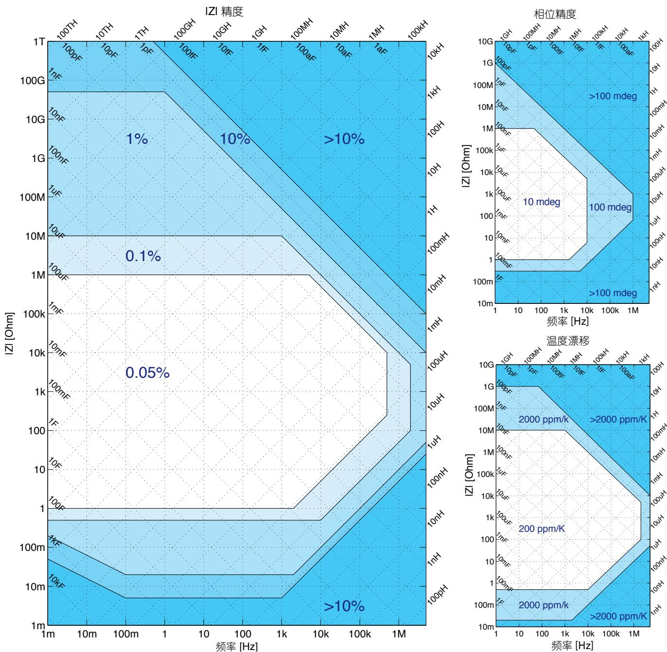
以上电抗图显示了 MFIA 在不同量程上的标称精度和温度漂移。
