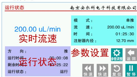
“单推/单拉”模式运行状态画面，点击功能按钮可以进行以下操作：暂停、运行、复位、参数调整、快进、快退等。
