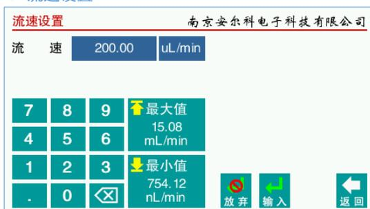
输入“单推/单拉”模式流速，点击单位条目可设置流速单位。输入时请注意数据范围，可以直接点击按钮输入最大或最小值。
