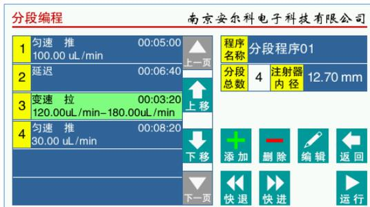
浏览或修改分段程序，点击条目设置程序名称、注射器内径，点击功能按钮增删分段、编辑分段、调整分段次序、运行操作。
