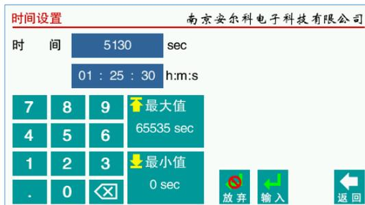
输入“单推/单拉”模式运行时间的总秒数或时分秒数据。输入时请注意数据范围，可以直接点击按钮输入最大或最小值。
