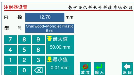
输入注射器内径，或点击“型号”条目选择内置注射器型号。输入时请注意数据范围，可以直接点击按钮输入最大或最小值。
