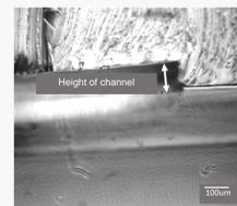
**Figure 4:** Height of PDMS LOC device.
