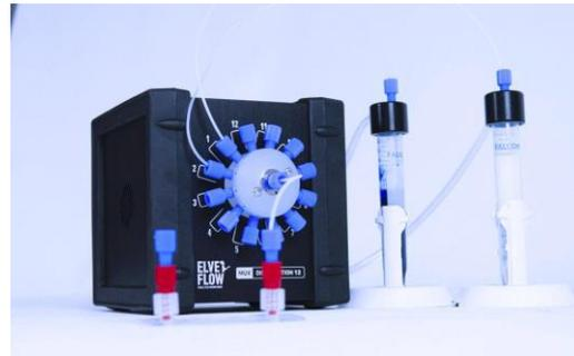
旋转切换阀是一种双向13-端口/12路切换阀，可用作选择器，将一种液体样品顺序注入12条不同的通路中或12种液体样品注入到1条通路中。
